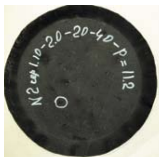
Рис. 2. Вид образца пленочной мембраны после испытания и нанесения маркировки
